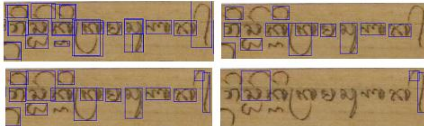
Fig. 9. Haut-gauche: segments de glyphe de vérité de terrain, Bas-gauche: segments de glyphe résultats, Haut-droite: segments de glyphe avec un chevauchement correct, Bas-droite: mauvais segments de glyphe
